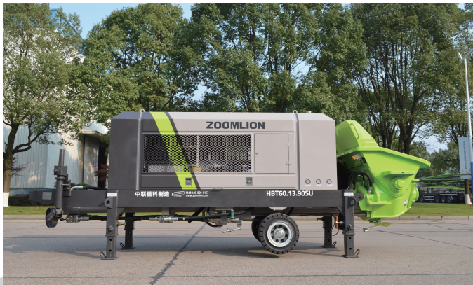
隧道专用混凝土泵。
