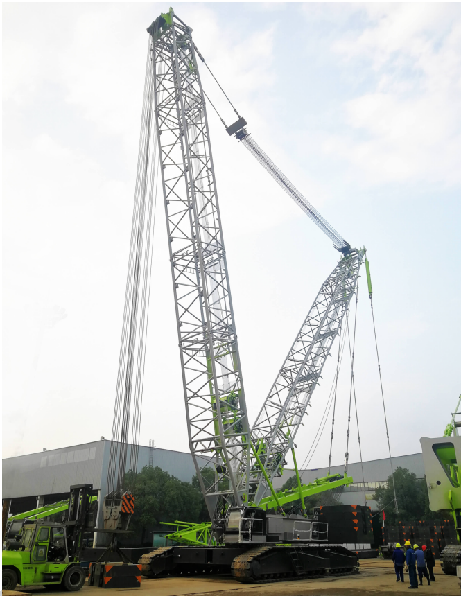
ZCC4000V 履带起重机正在进行调试试验。
