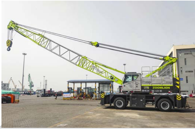
中联重科全球首款全电驱 ZPT550VEV 港口轮胎起重机。高精精 供图
