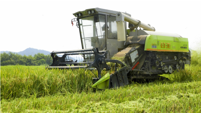
中联重科履带式谷物联合收割机在田间作业。
